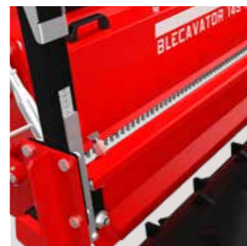
Nivellierbalken für eine glatte und ebene Oberfläche.
