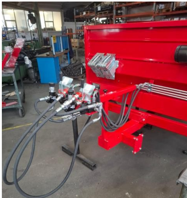
Fig. 10: Hydrauliksystem og hydraulikholder monteret
