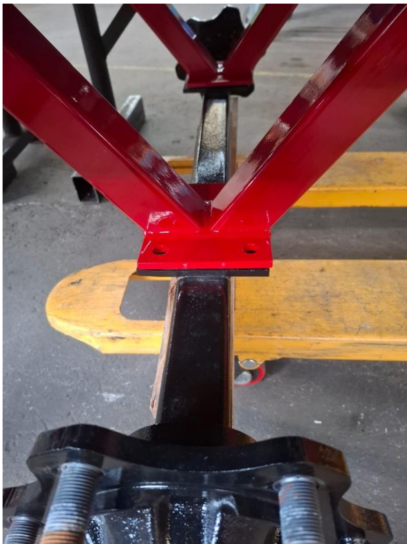
Fig. 16: Monter akslen på akselbeslagene
