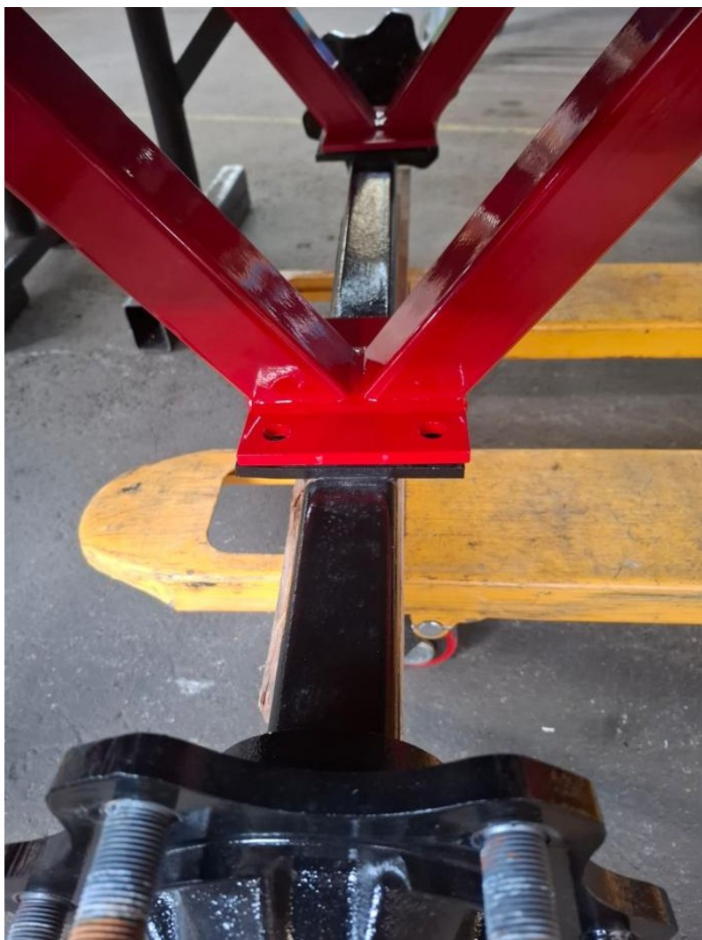
Afb. 16: Monteer de as op de asbeugels
