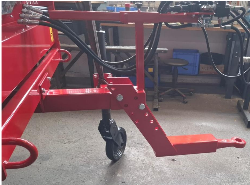
Afb. 25: Onderste koppeling geïnstalleerd
