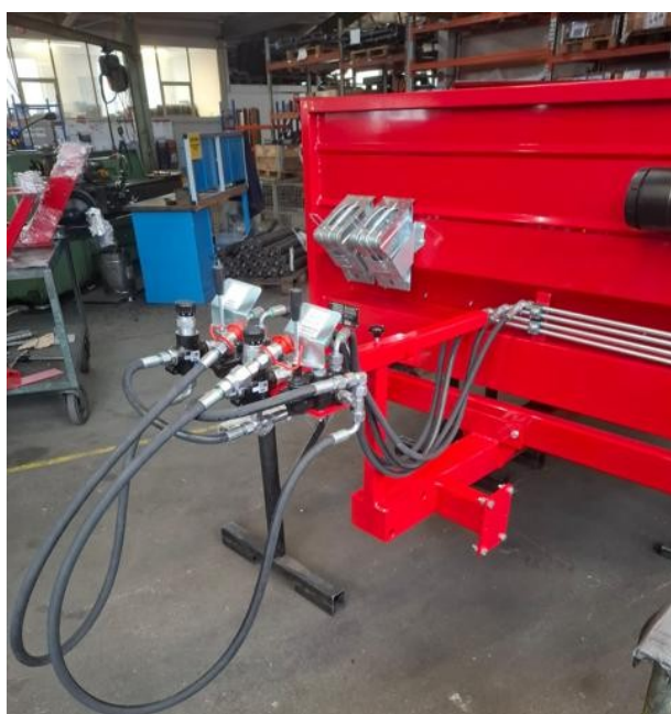
Afb. 10: Hydraulisch systeem en hydraulische houder geïnstalleerd
