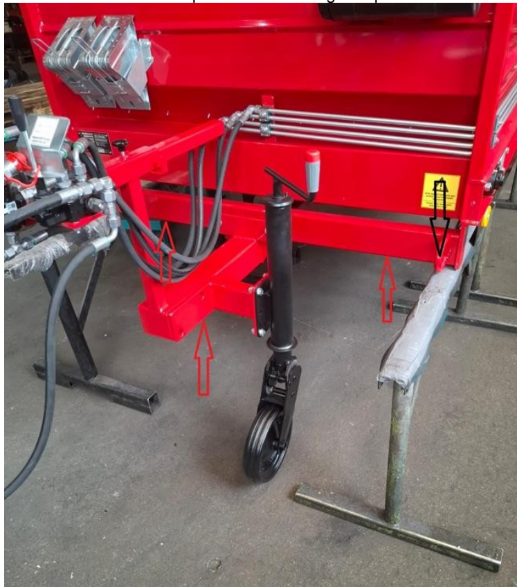
Fig. 19 : Points de levage – haut et bas
