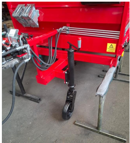
Fig. 18 : Roue d'appui installée
