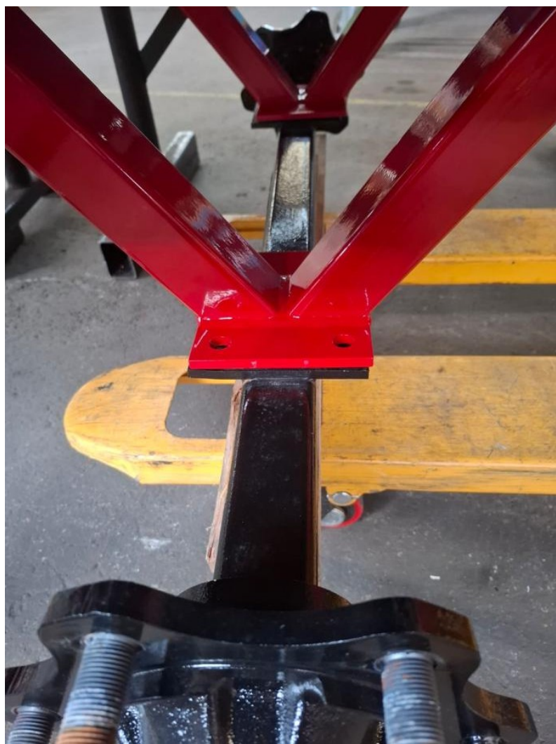
Fig. 16 : Montez l'essieu sur les supports d'essieu
