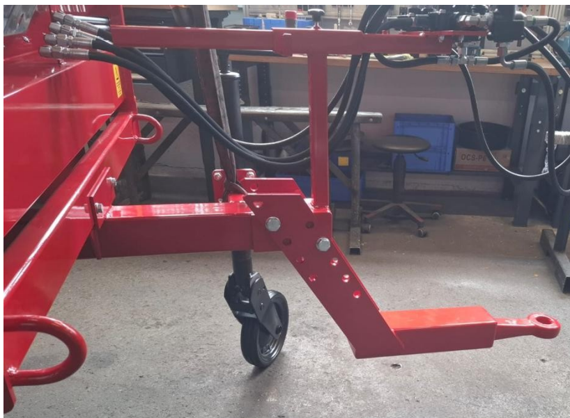
Fig. 25 : Attelage inférieur installé
