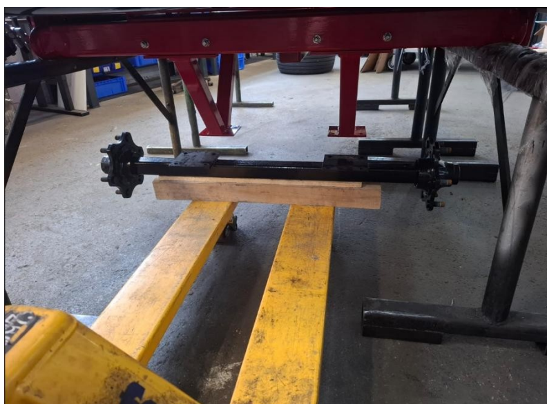
Fig. 15 : Positionnement de l'essieu
