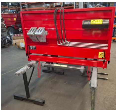
Fig. 3 : Points de levage – haut et bas
