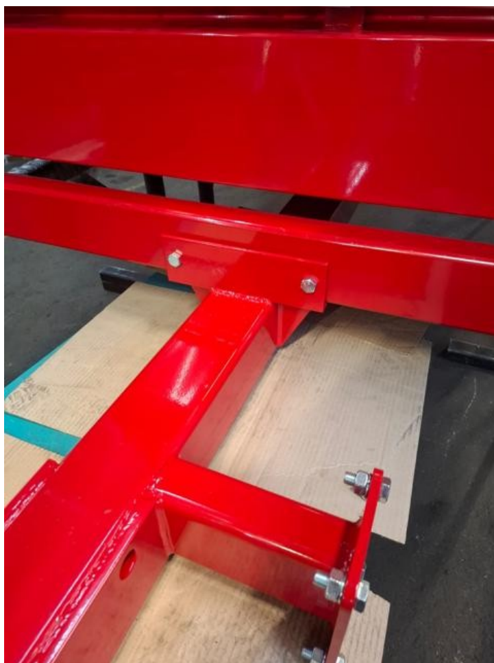
Fig. 9 : Tube de timon monté
