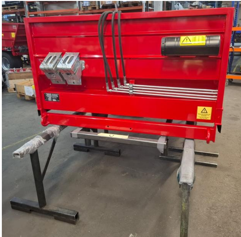
Abb. 6: Maschine auf geeignete Montageböcke – vordere Ansicht
