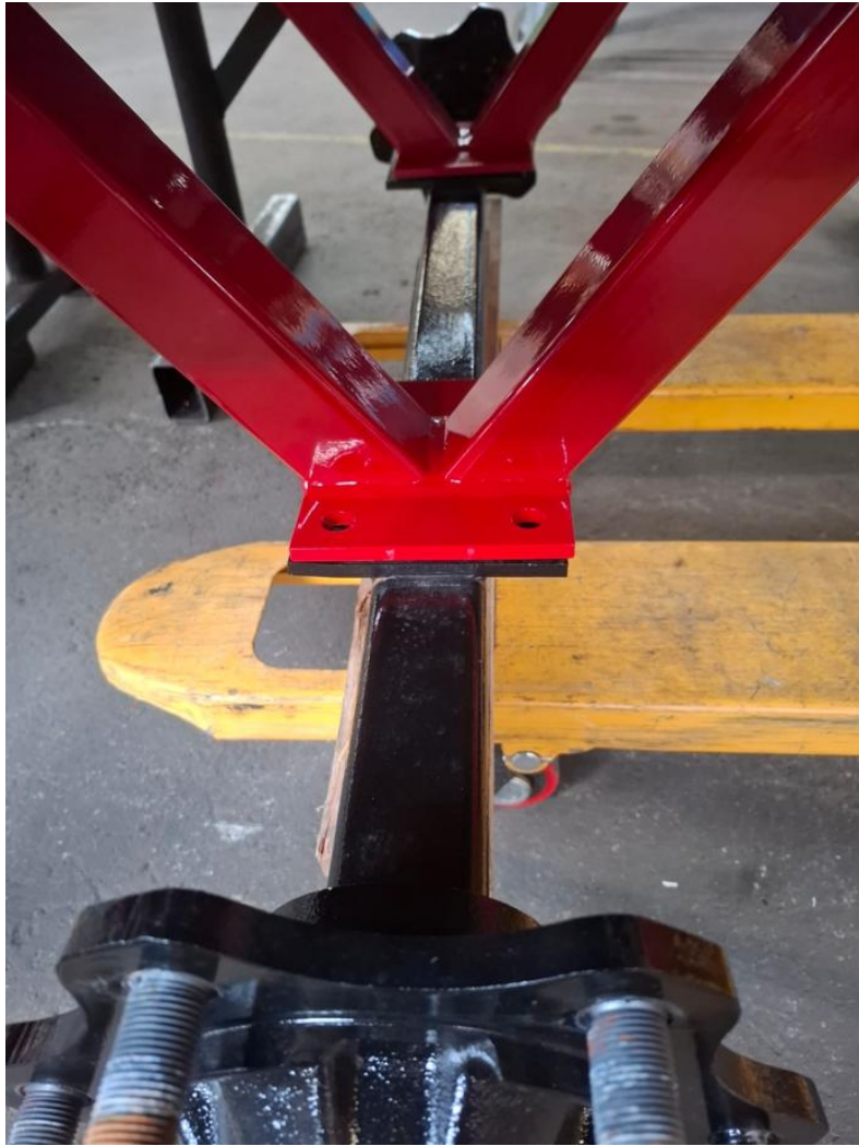
Abb. 16: Achse an Achsböcke montieren
