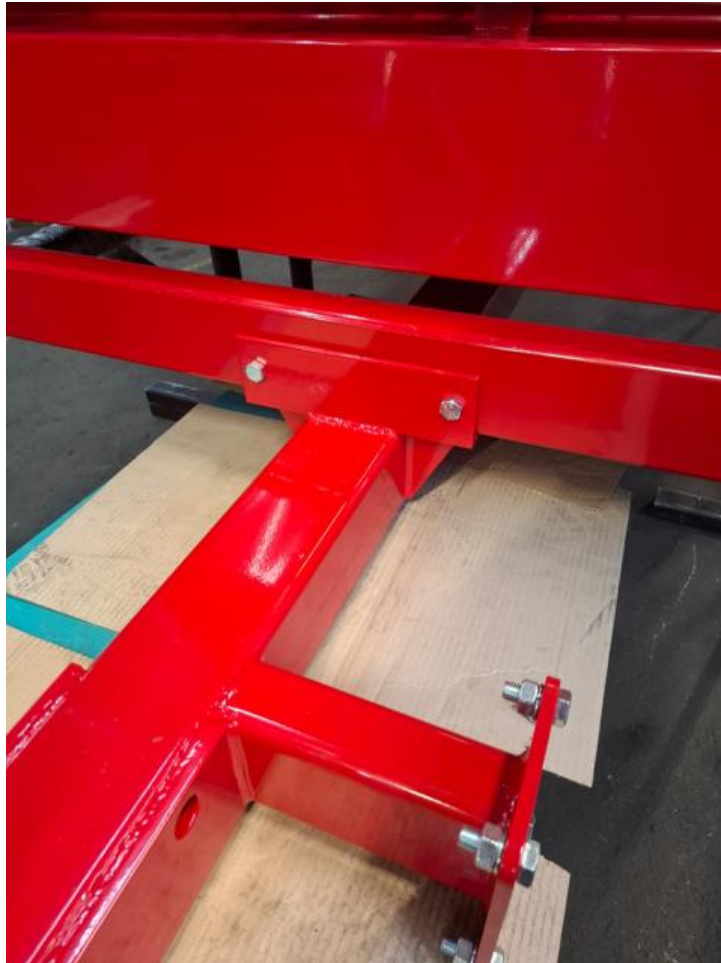
Abb. 9: Deichselrohr mit Befestigungsmaterial montiert
