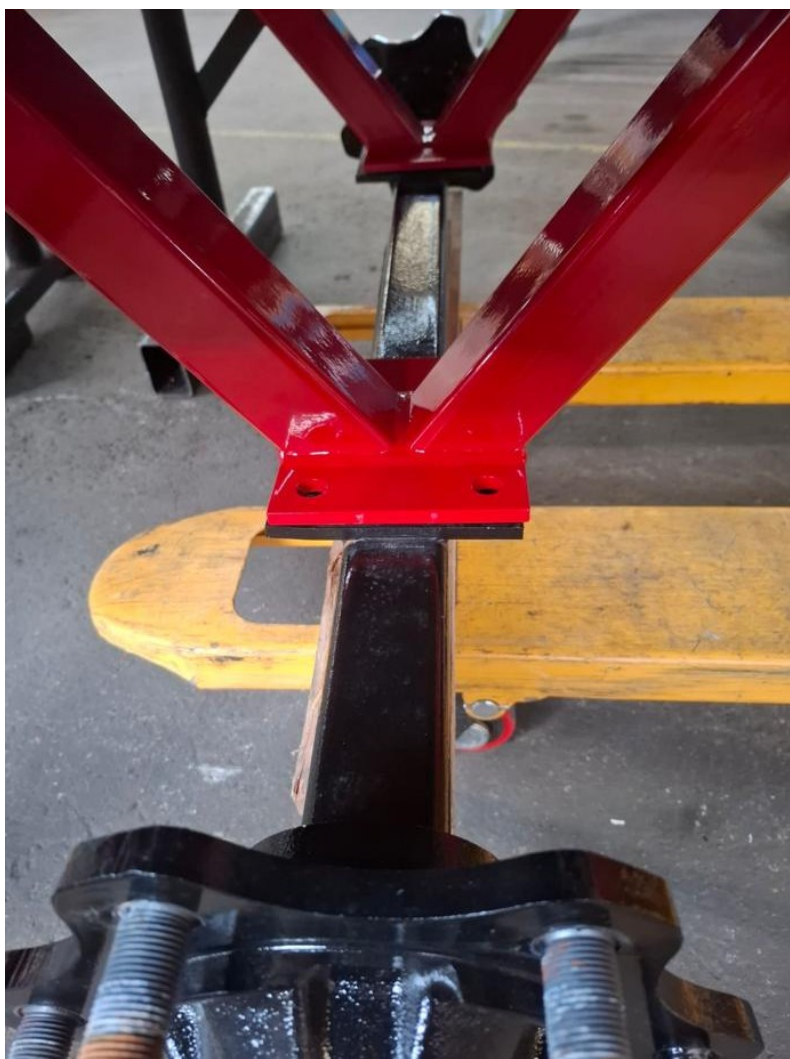
Fig. 16: Montare l'asse sulle staffe dell'asse
