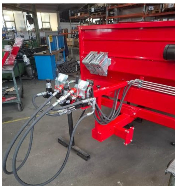
Fig. 10: Impianto idraulico e supporto idraulico montati
