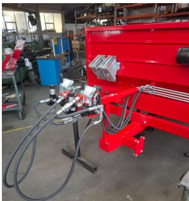
Rys. 10: Zainstalowany układ hydrauliczny i uchwyt hydrauliczny
