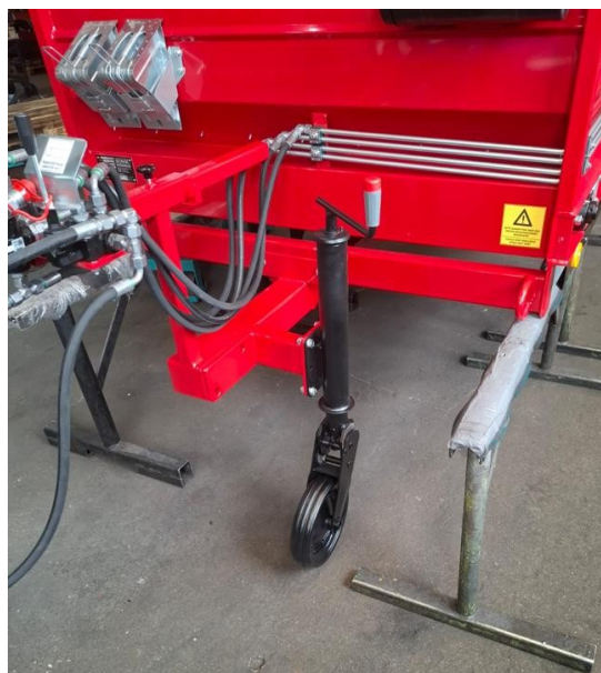
Rys. 18: Zamontowane koło podporowe
