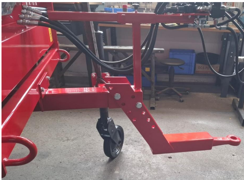
Rys. 25: Zamontowany dolny zaczep
