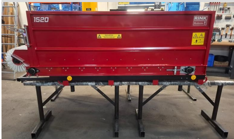
Fig. 5: Máquina sobre soportes de montaje adecuados – vista lateral
