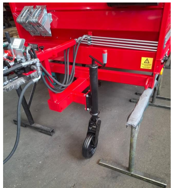
Fig. 18: Rueda de apoyo instalada
