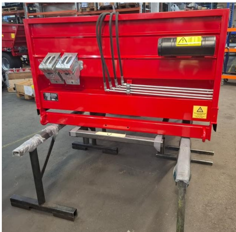
Fig. 6: Máquina sobre soportes de montaje adecuados – vista frontal
