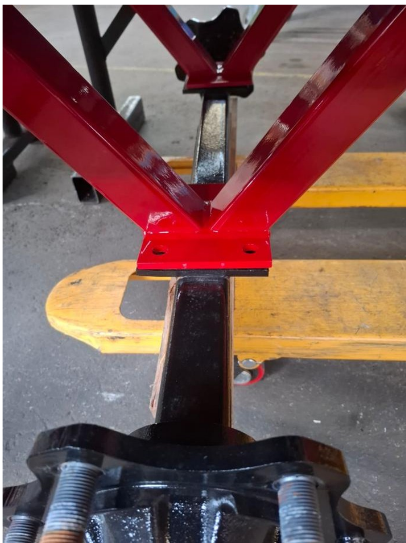
Fig. 16: Montar el eje en los soportes del eje
