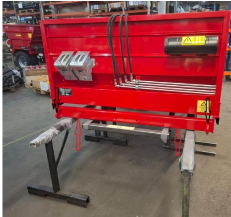
Abb. 3: Lyftpunkter – upptill och nedtill
