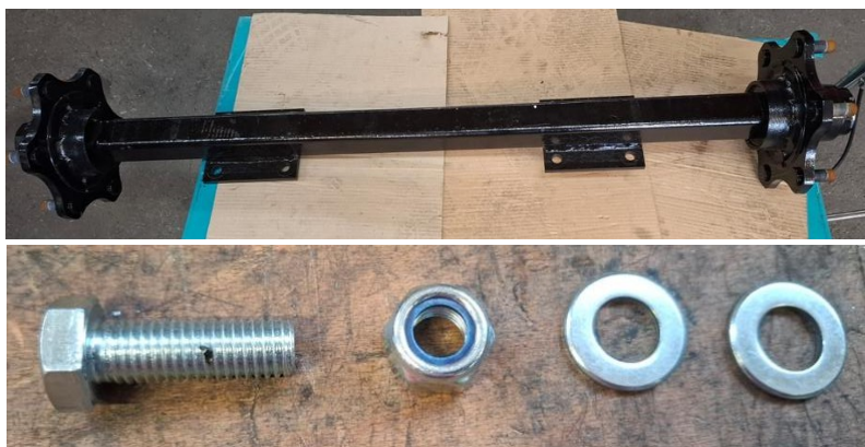
Abb. 14: Axel och fästdetaljer
