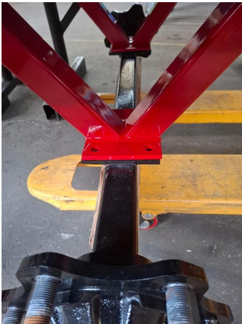
Abb. 16: Montera axeln på axelfästena
