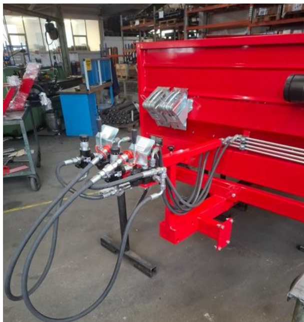
Abb. 10: Hydraulsystem och hydraulhållare monterade
